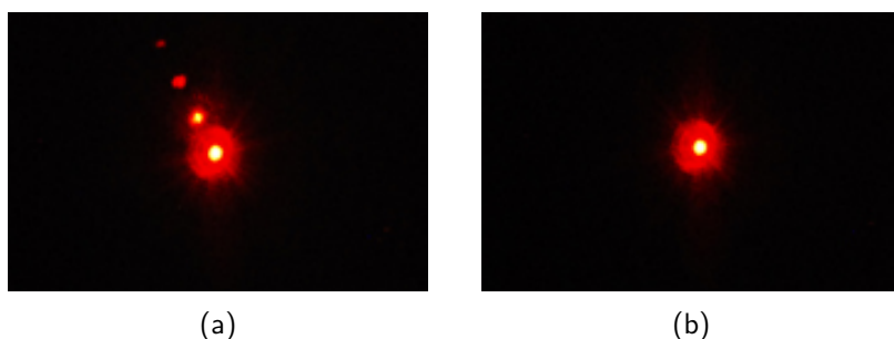
Fig. 7 – Réglage du parallélisme entre séparatrice et compensatrice à l'aide d'un laser a Le parallélisme n'a pas été réglé, de multiples taches sont visibles. Le défaut de parallélisme est ici volontairement exagéré. b Après réglage du parallélisme, une seule tache demeure.
